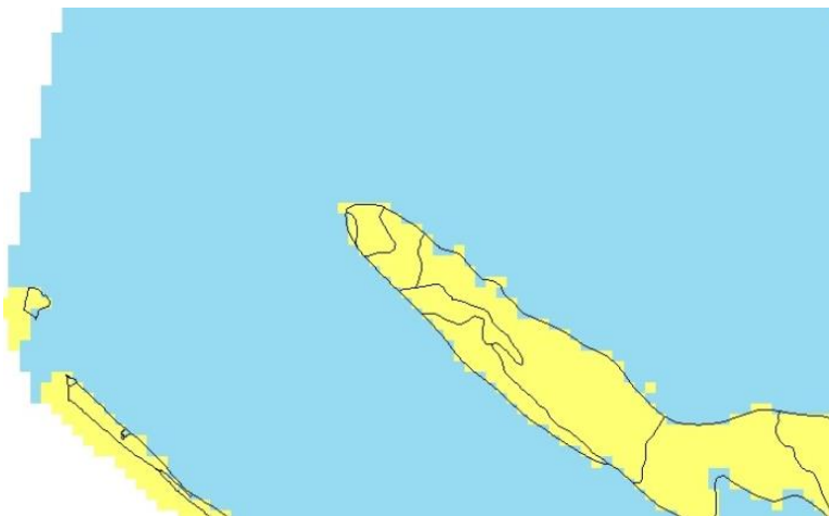
Figuur 5.4 Voorbeeld van de 4 procent droogvalduur grensovergang tussen litoraal (geel) en sublitoraal (blauw). De grens moet overeenkomen met de grens van de geomorfologische kaart (zwarte lijn).
