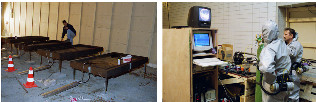
Figuur 5.5 Opstelling voor panbranden in buis D (links) en buis C (rechts).
