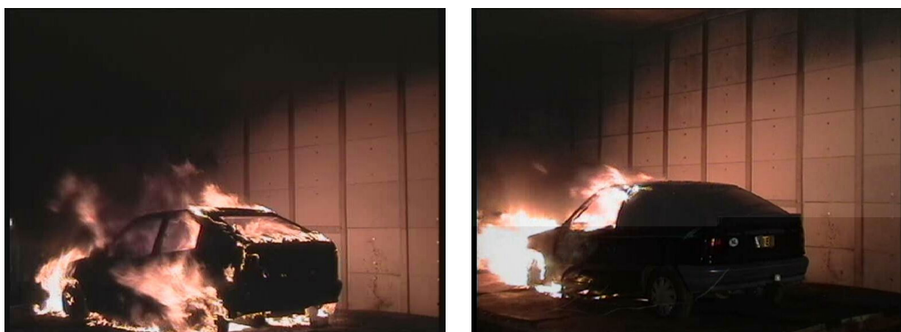
Figuur 11.2: Waargenomen brandgedrag personenautobrand zonder ventilatie (links) en met 6 m/s ventilatie (rechts).
