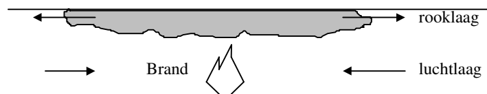
Figuur 8.1 Schematische voorstelling van stratificatie bij brand in een tunnel.
