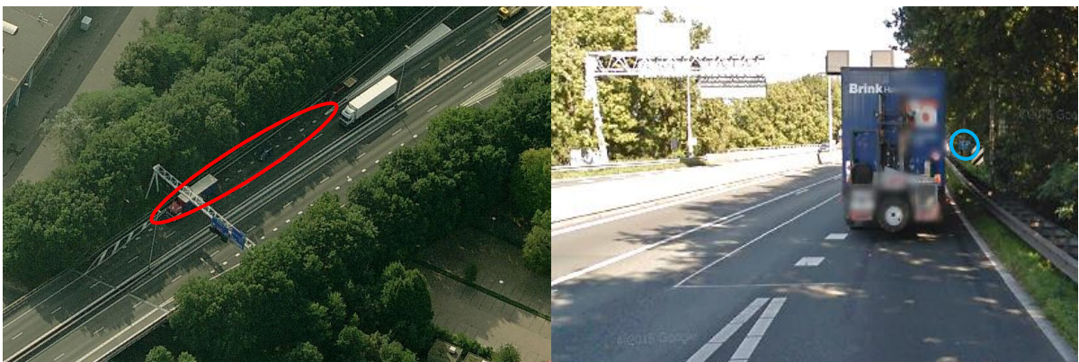
Figuur 2.11. Korte invoegstrook in een gebied met veel vrachtverkeer (A27) vanuit bovenaanzicht (rode cirkel linker afbeelding) en vanuit het perspectief van de weggebruiker (rechter afbeelding, bord in blauwe cirkel staat aan het einde van de invoegstrook).
