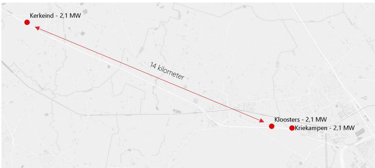
Figuur 5: Twee opeenvolgende locaties die net een grote aansluiting nodig hebben (voorzieningsgebied van Enexis waar de grens op 1,75MW ligt). Het is aan te raden om enkele snelladers van Breehees/Kerkeind te verplaatsen naar Kriekampen/Kloosters waar een knooppunt in het net dichterbij ligt dan bij Kerkeind.
