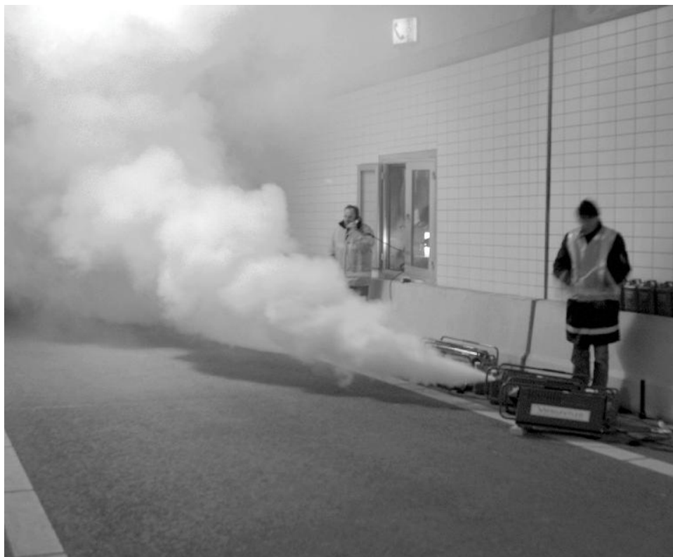
Fig. 6 Rookproductie in de tunnel.
