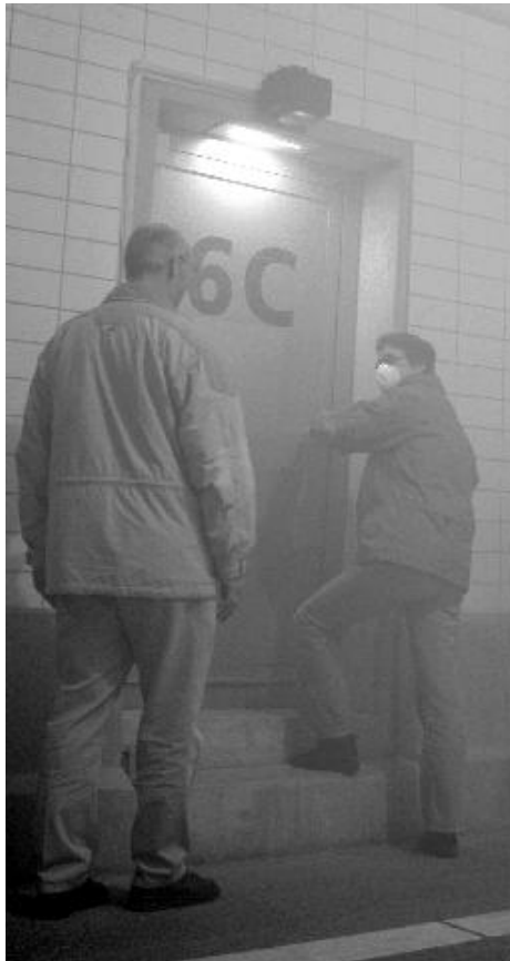
Fig. 3 Vluchtdeur 6 met geluidsbaken op de bovendorpel, de zwarte vierkante doos. (Testassistenten bereiden de proef voor; er is nog nauwelijks rook.)
