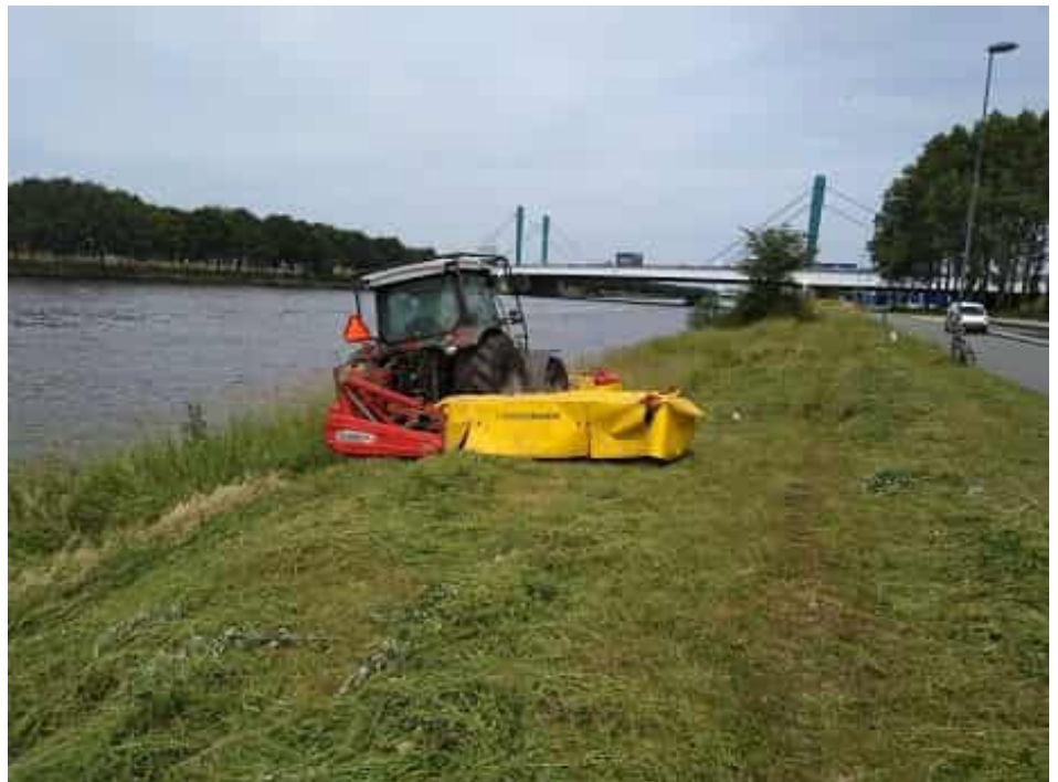
Maaien van de vegetatie met een schotelmaaier. Gebruik van klepelmaaiers is niet toegestaan. Amsterdam Rijnkanaal. Foto Peter-Jan Keizer.
