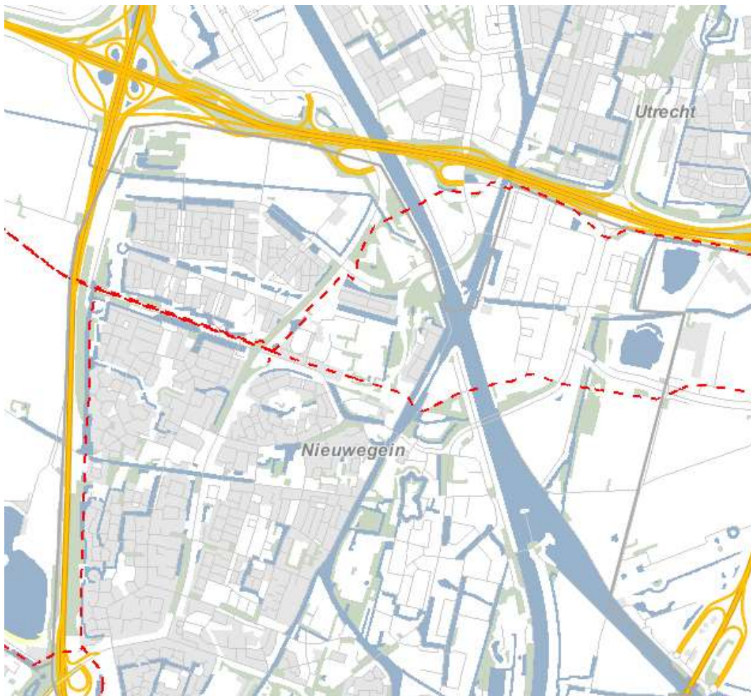
Figuur 13 Ligging gasleiding (zuid) en kerosineleiding (noord)
