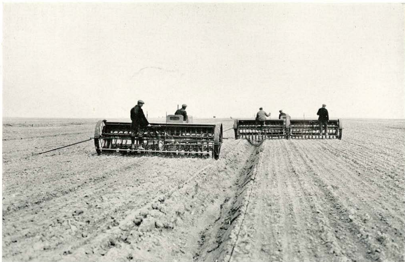
N o . 6. Zaaimachines van 4 en van 6 m werkbreedte. Het ongerief der greppels opgelost.
