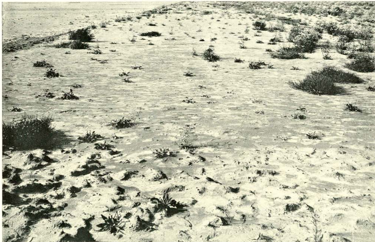
Nº. 8. Natuurlijke begroeiing op het ontwateringsproefveld nabij Kolhorn; in den linkerbovenhoek een niet ontwaterde, in den rechterbovenhoek een gedraineerde strook, in het midden de op 15 m gedraineerde overgangsakker.
