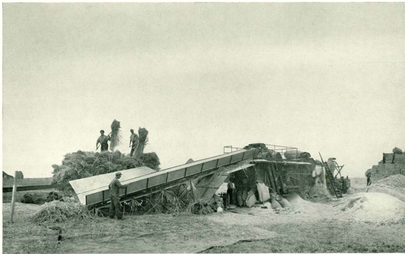
N o . 1. Een van de eigen dorschmachines (Ned. fabriikaat), voorzien van een langstrporteur, in bedrijf.
