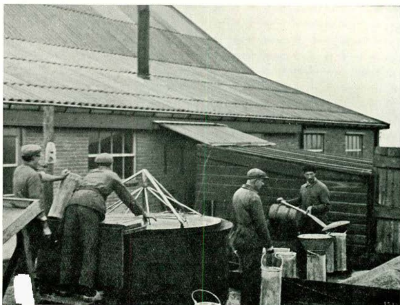
Nº. 7. Ontsmettingsketel voor granen met een capaciteit van 70/80 hl per dag. (Foto Prof. Visser, Wageningen.)
