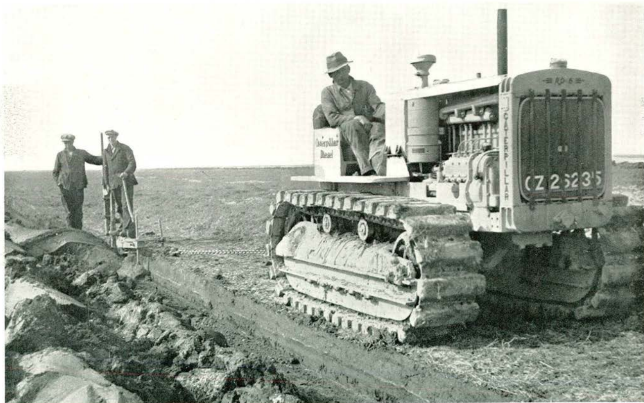
4. Diepploegen: Het bovenbrengen van klei, bedekt met een laag zand van 30 à 50 cm. Ploegdiepte \pm 80 cm.
