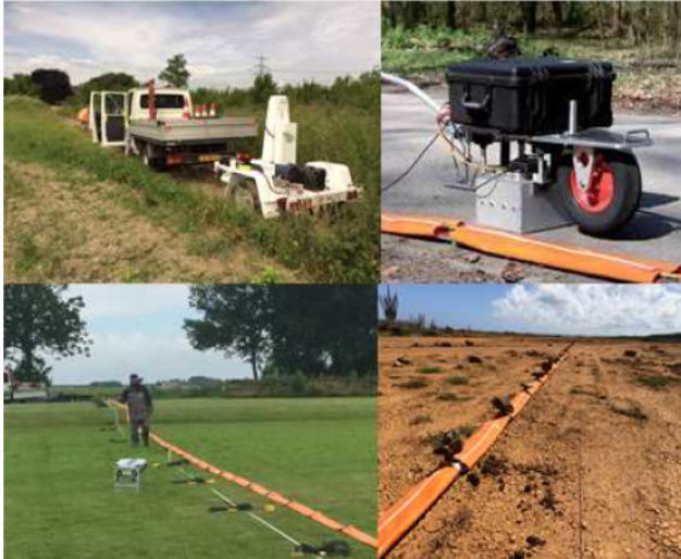
Figuur 2.3 Enkele voorbeelden van seismische bronnen (boven) en de opnemers (onder), de opnemers bestaan uit een gesleept systeem (een landstreamer) of een gestoken array (met in de grond gestoken geofoons), het voordeel van de landstreamer is de meetsnelheid, het voordeel van de gestoken opstelling is de hogere kwaliteit van de resultaten
