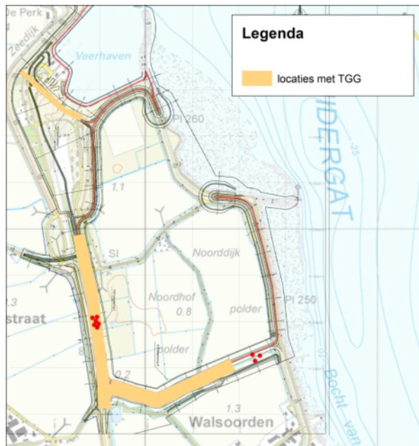
Figuur 1.1 Locatiekaart Primaire waterkering Perkpolder met TGG materiaal. Dijk oost-west onderaan is kering B. Dijk zuid-noord daarop aansluitend is kering C. Kering meer in het noorden met TGG is kering E. Monstername in kering E schijnt zeer lastig.
