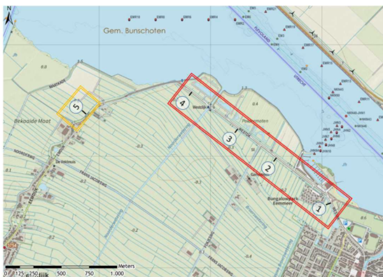
Figuur 1: Schematisch bovenaanzicht met de vier transecten langs de dijk met aangebracht ATM zand (zwarte strepen in rode rechthoek), en het referentie transect (zwarte streep in oranje rechthoek).
