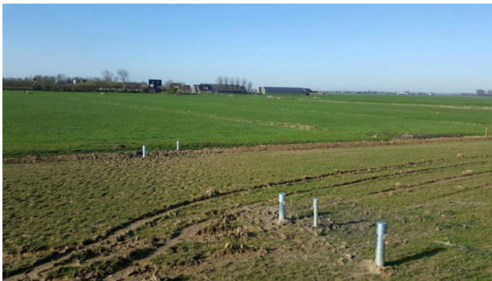
Foto 3. Een voorbeeld van een van de transecten met peilbuizen en ceramische cups langs de dijk.
