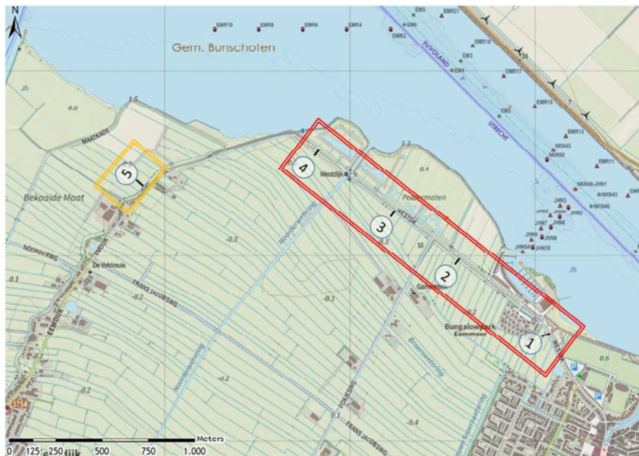
Figuur 1: Schematisch bovenaanzicht met de vier transecten langs de dijk met aangebracht ATM zand (zwarte strepen in rode rechthoek), en het referentie transect (zwarte streep in oranje rechthoek).
