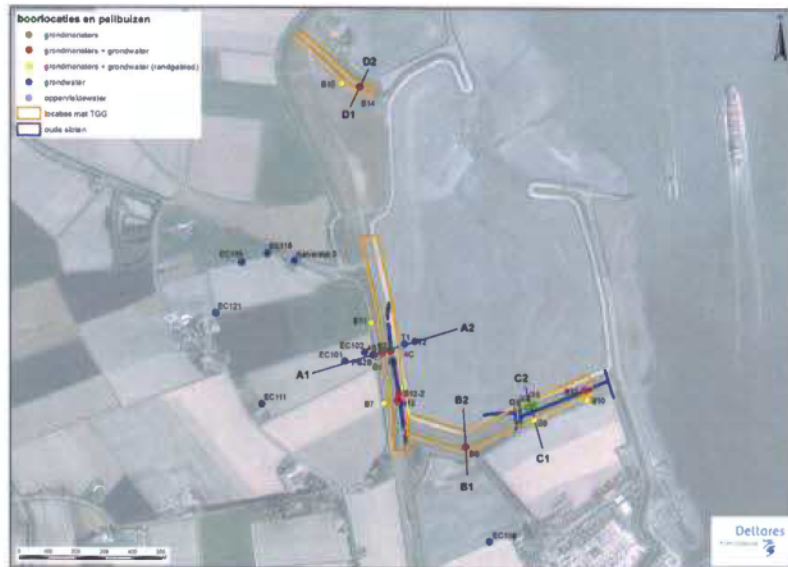
Figuur 2.1 Indicatieve ligging van de zeedijk waar de TGG is toegepast, de ligging van de vier meetraaien A t/m D en de ligging van de verschillende locaties waar de grond, het oppervlaktewater en het grondwater is bemonsterd
