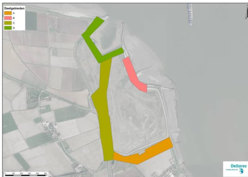
Figuur 2.2 Dijkvakken waarin TGG is toegepast, liggen in de Deelgebieden A, C en D. Deelgebied B betreft de voormalige zeedijk die bij de ontpoldering is verwijderd
