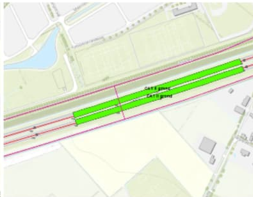
Figuur 4.17 Locatie 14.3 A58 omlegging Etten-Leur, vermelding toepassing cat 2 grond km 77.008 - 78.408 (bron: GIS-bestand RWS ZN).
