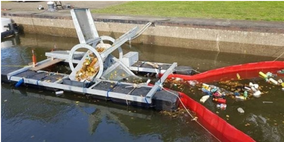
Figuur 4 Afvalscheprad dat getest wordt bij de sluis in Borgharen (2020).
