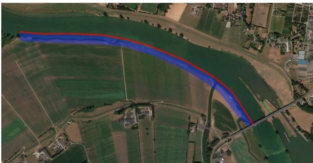
Figuur 13: Stuwgeul ingetekend bij stuw Grave (rechts). Het water in de zuidkant van de Maas (in blauw) zal sneller stromen dan de overige Maas. De twee delen van de Maas zijn gescheiden worden door een langsdam.
