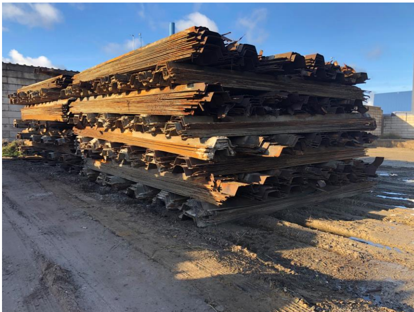
Afbeelding 2.2 Damwanden gestapeld opgeslagen in openlucht depot. Bron: K. Kranenburg, Beens Groep
