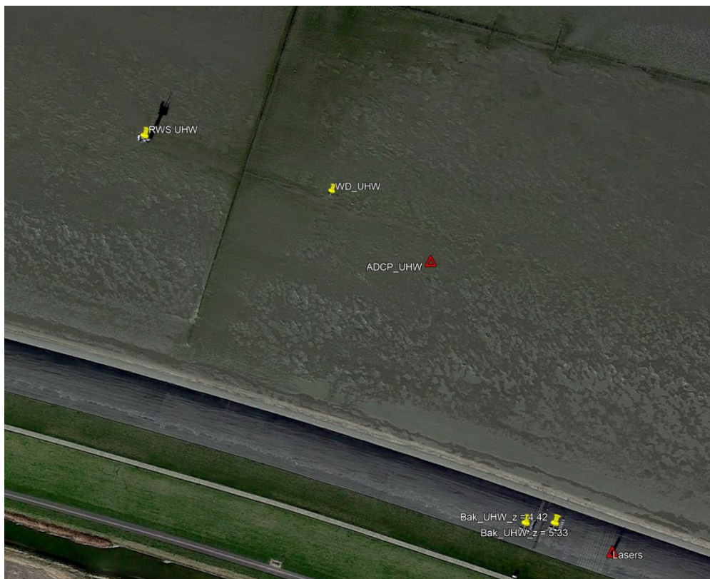
Figuur 1. Meetlocatie Uithuizerwad. RWS_UHW is de Rijkswaterstaatmeetpaal, WD_UHW de WaveDroid (boei), ADCP_UHW de ADCP. Bak_UHW zijn de overslagbakken en Lasers de laserscanneropstelling.
