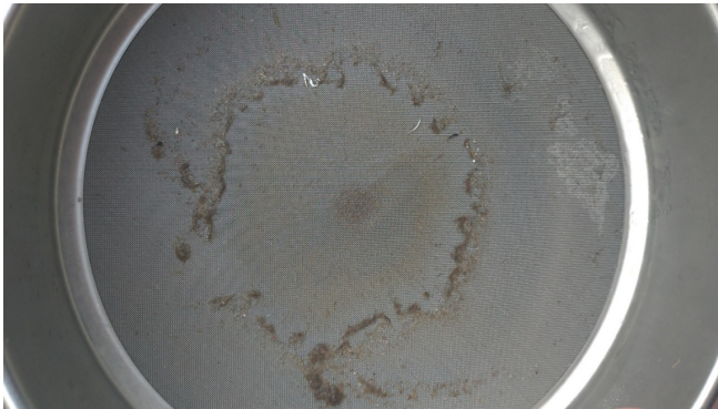
Figuur 10 Zwevend stof opbrengst op de grootste zeef (300 µm) van een cascade zeven, geplaatst achter een sedimentkist. Onafgebroken bemonstering gedurende 14 dagen bij een pompsnelheid van 4 liter per minuut op het RDM dok in Rotterdam. De witte stukjes zijn afkomstig van Teflon afdichting van de RVS leidingen.
