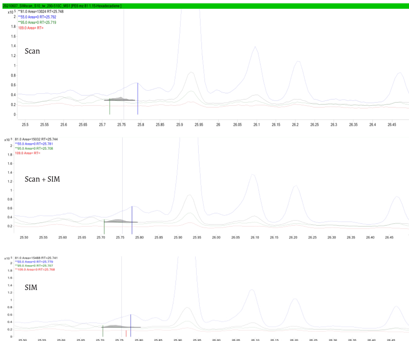
Figuur 10 Chromatogrammen van een Maasslib monster, gemeten als full scan, SIM+scan of SIM. Door bij GC-MS te kiezen voor de Scan + SIM, worden tegelijkertijd GC-MS data verzameld van andere dan doelstoffen (SCAN), zonder verlies aan gevoeligheid ten opzichte van Selected Ion Monitoring (SIM)
