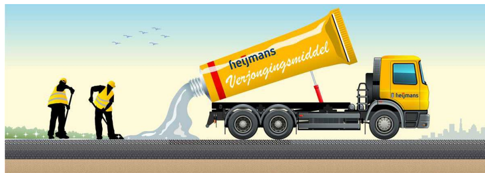
Heijmans is aan het experimenteren om de levensduur van asfalt te verlengen met een zogenaamde verjongingsmiddel. [heijmans.nl]
