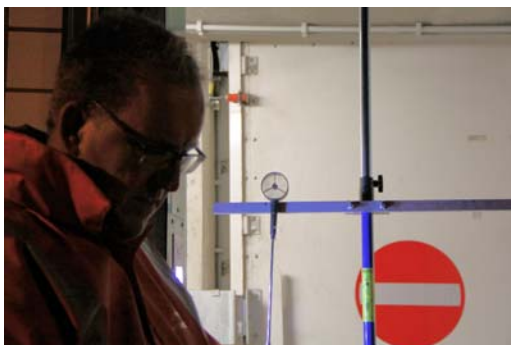
Metten luchtsnelheid door geopende vluchtdeur, met velometer
