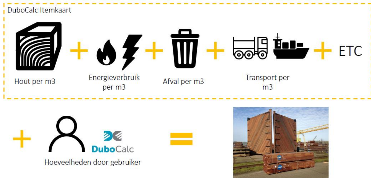
Figuur 8: Mogelijk gebruik in DuboCalc van een Itemkaart van één m 3 hout met mogelijke standaarduitgangspunten, voor een sluisdeur.
