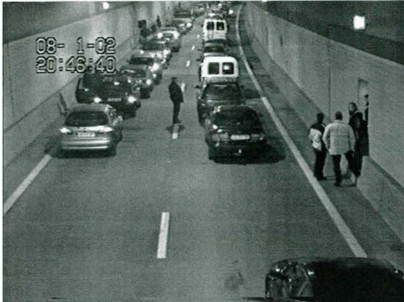
Fig. 14 Een evacuatie verzandt. Drie minuten nadat de eerste door de vluchtdeur ging zijn weggebruikers weer terug bij de auto en hangen ze rond de vluchtdeuren.
