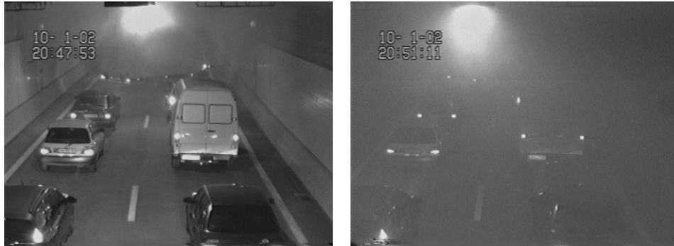
Fig. 16 De voorste auto's bij proef 6 verdwijnen geleidelijk in de rook maar de bestuurders blijven rustig zitten. (Gestreefd werd naar een langzame rookafvoer in de rijrichting; bij deze proef was er te veel "tegenventilatie".)
