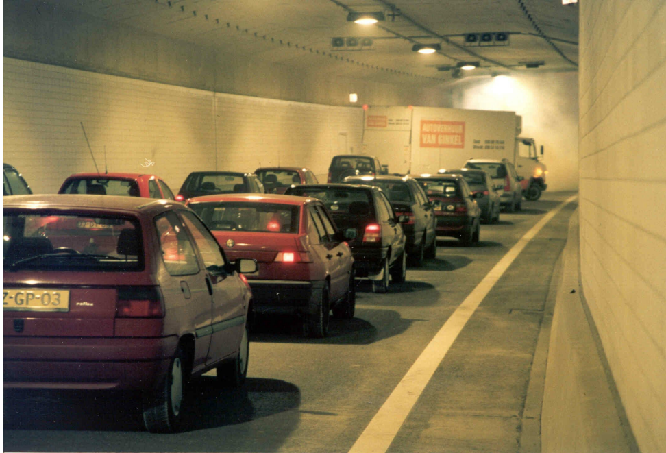
Fig. 12 Een brandende vrachtauto. (Rookgeneratoren staan hier op de rijbaan achter de vrachtauto; niet, zoals bij de echte proeven, in de vrachtwagen zelf.)
