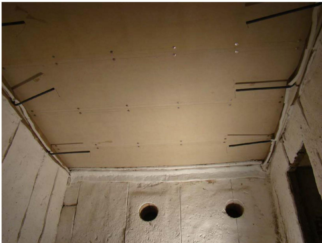
Foto 1: Verhit oppervlak voor de brandproef
