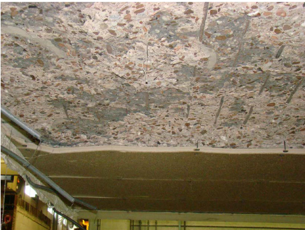
Foto 4: Details van het verhitte oppervlak na de brandproef
