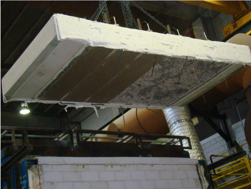
Foto 3: Verhit oppervlak na de brandproef
