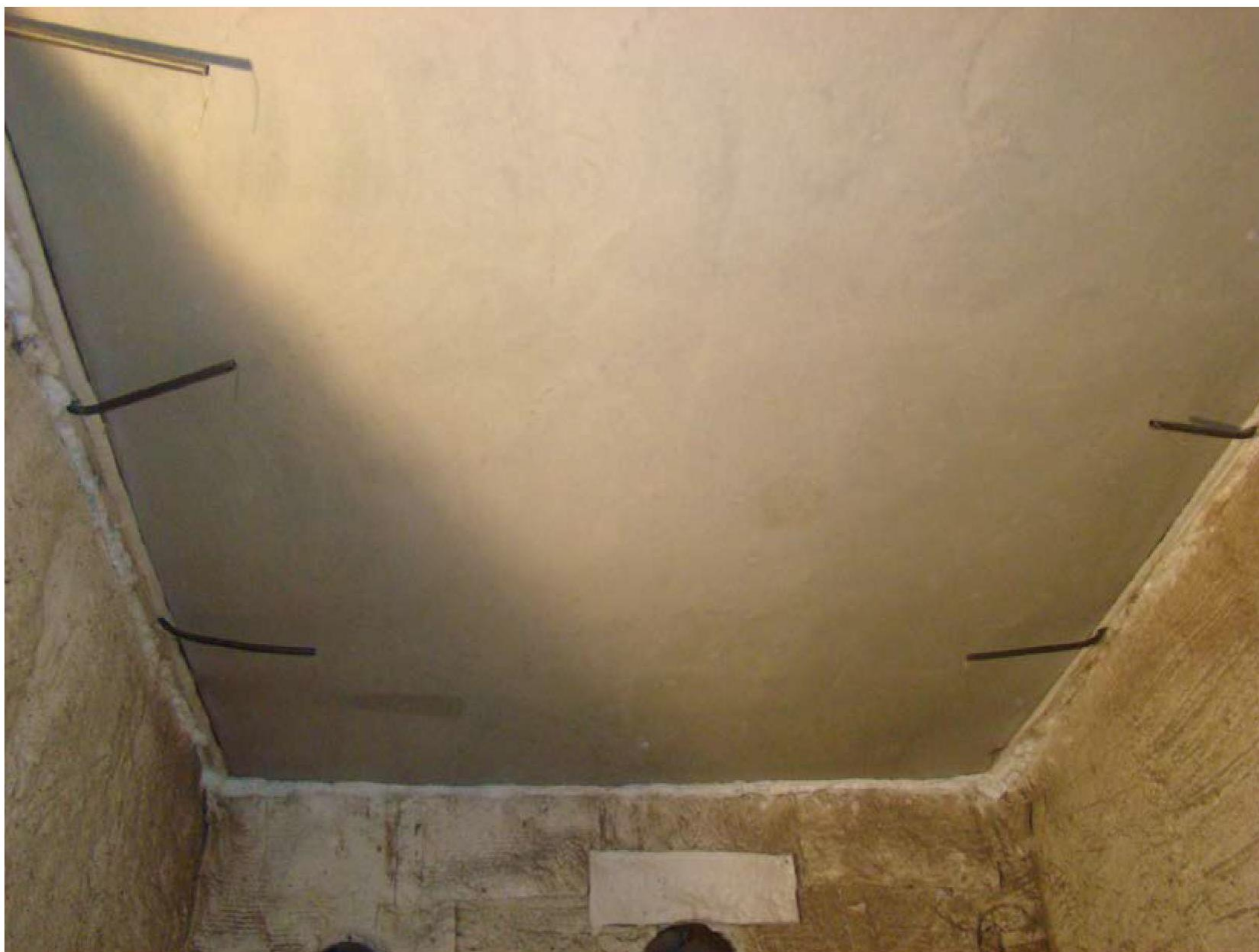
Foto 1: Verhit oppervlak voor de brandproef
