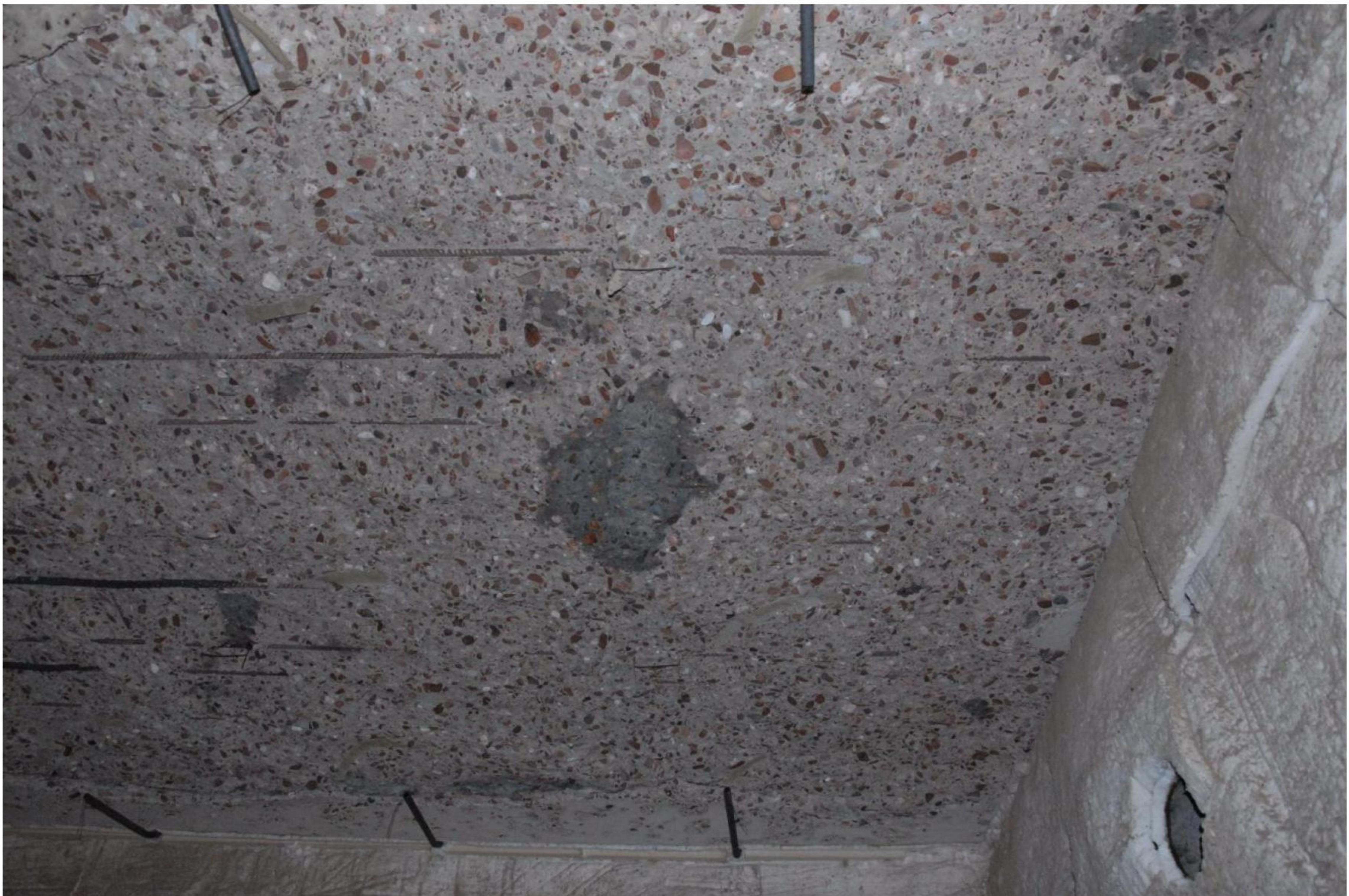
Foto 4: Verhit oppervlak na de brandproef
