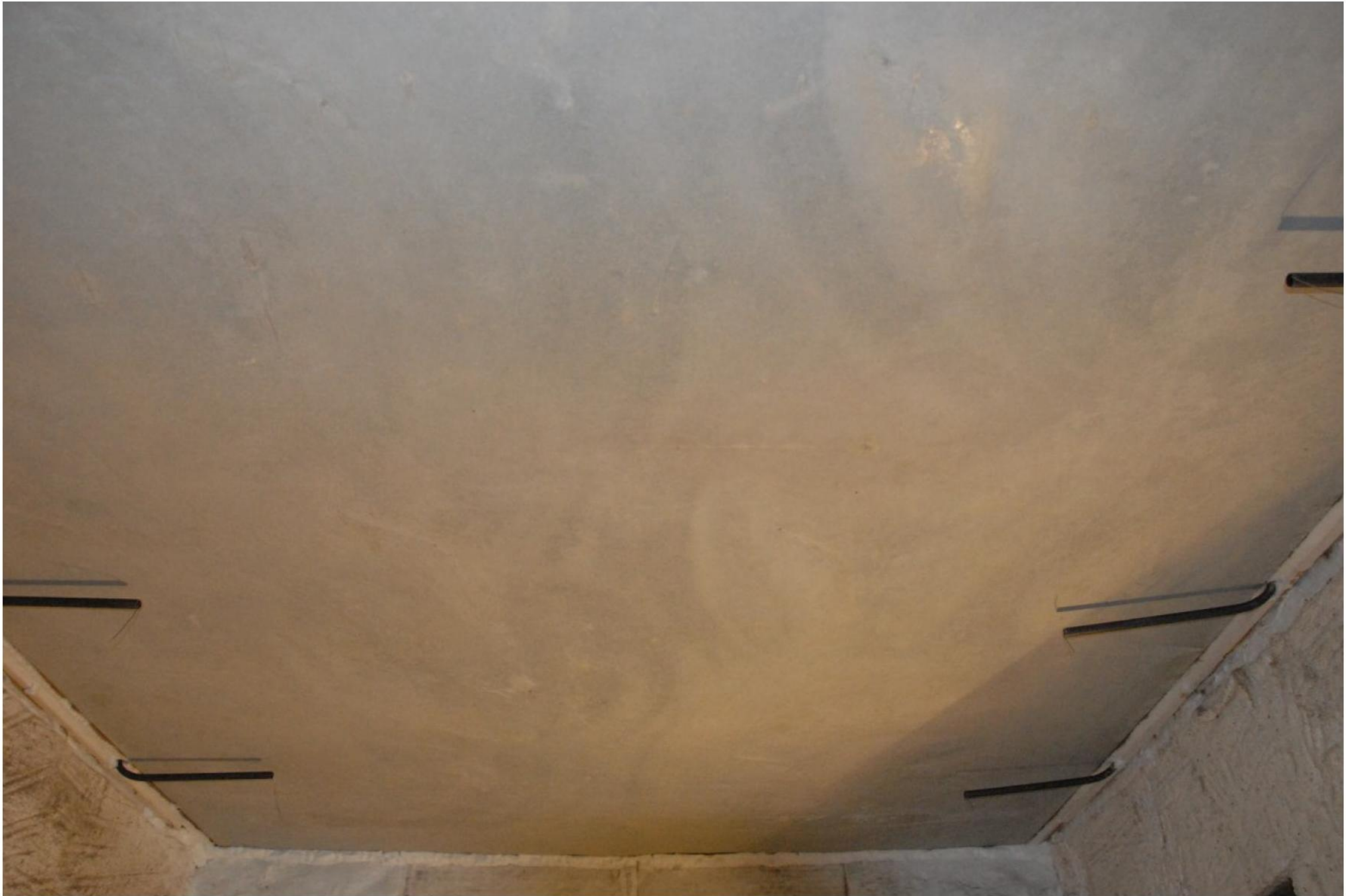
Foto 1: Verhit oppervlak voor de brandproef
