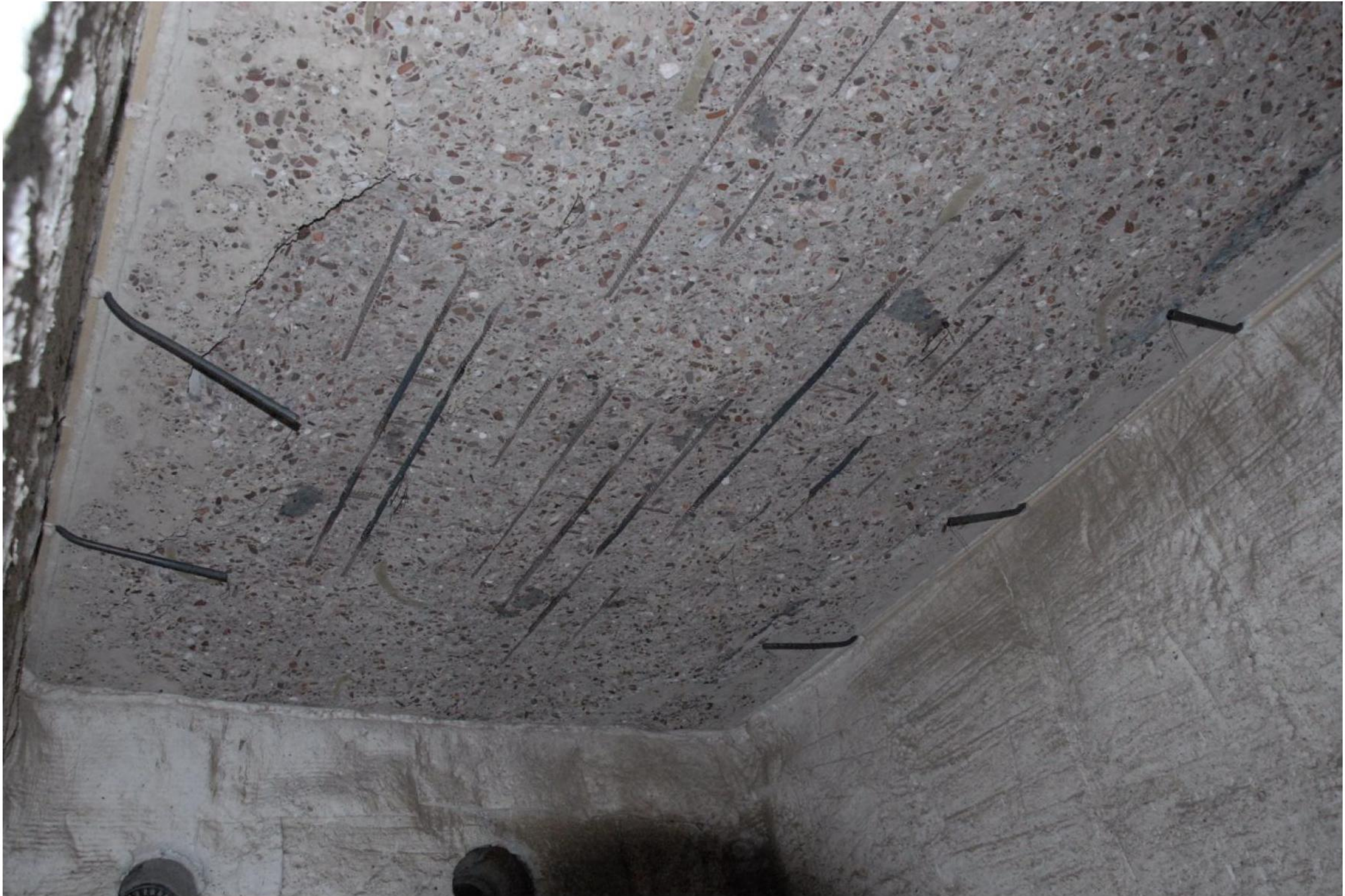
Foto 3: Verhit oppervlak na de brandproef
