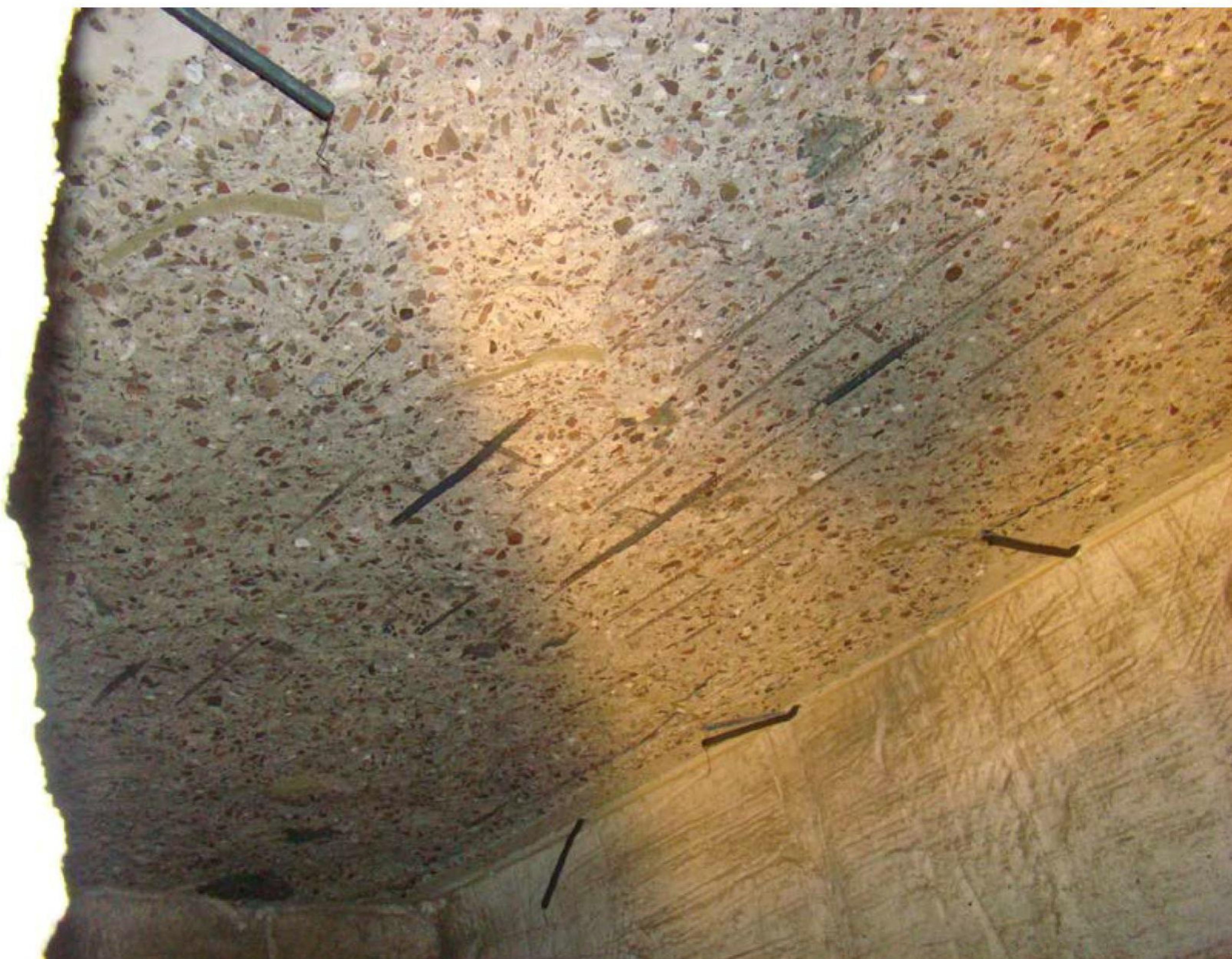
Foto 4: Verhit oppervlak na de brandproef
