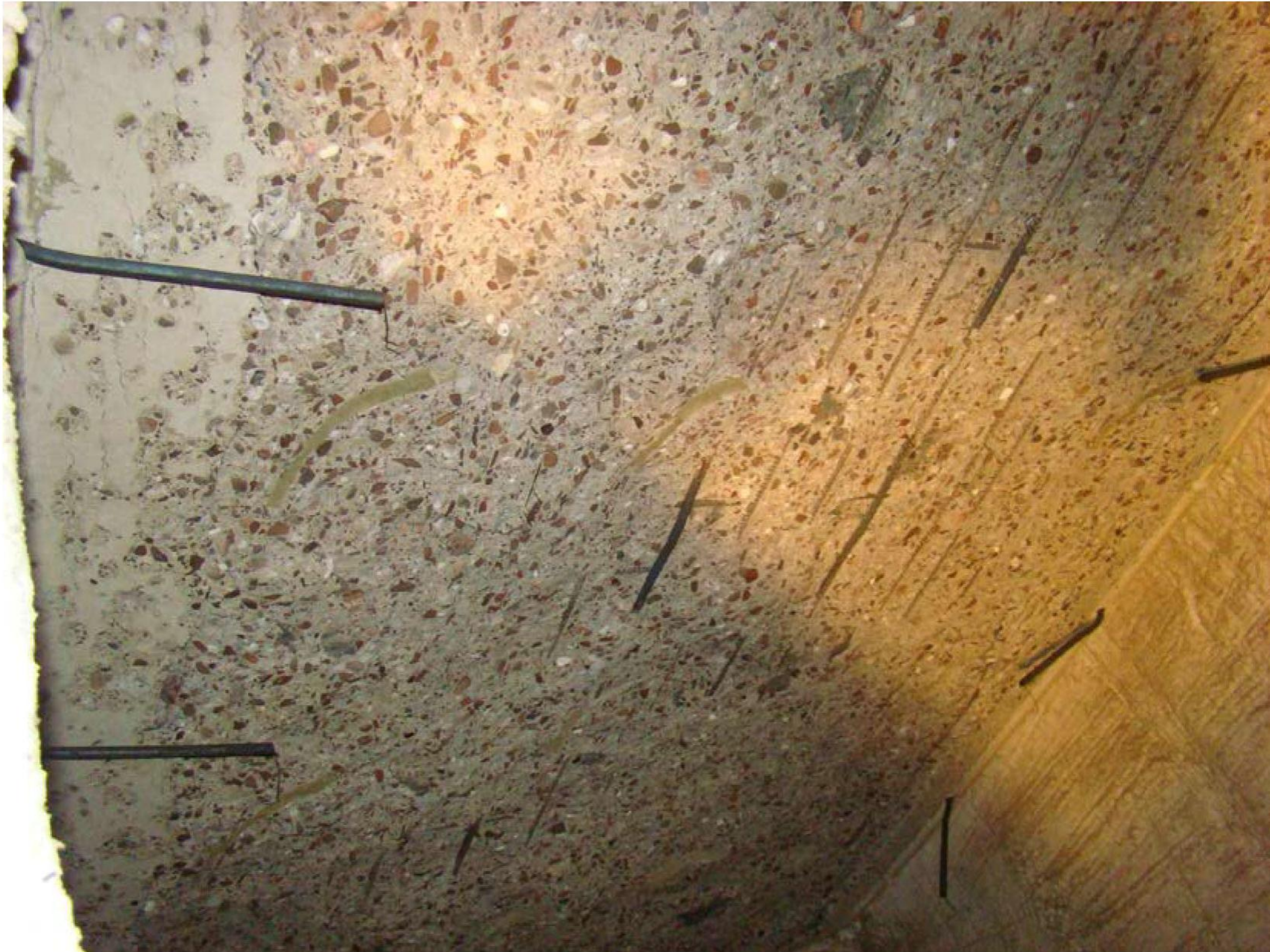
Foto 3: Verhit oppervlak na de brandproef
