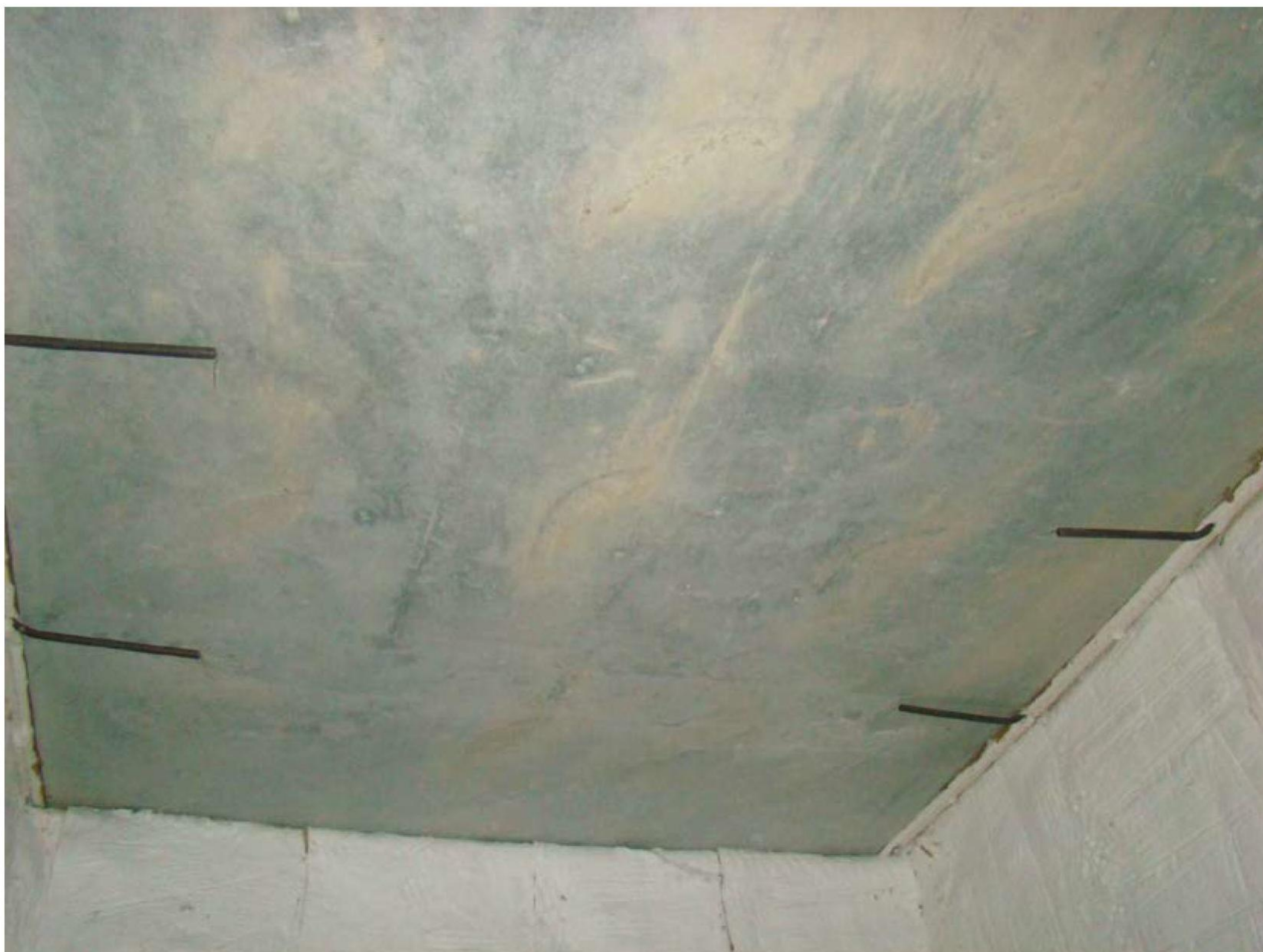
Foto 1: Verhit oppervlak voor de brandproef
