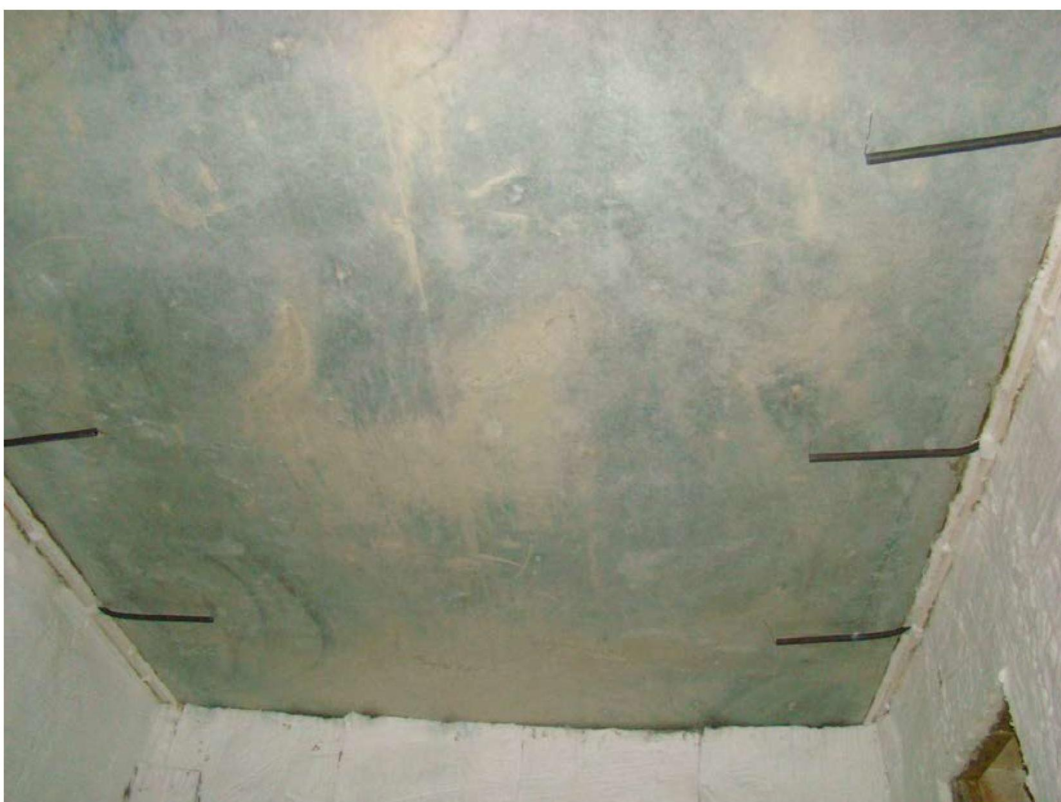
Foto 2: Verhit oppervlak voor de brandproef
