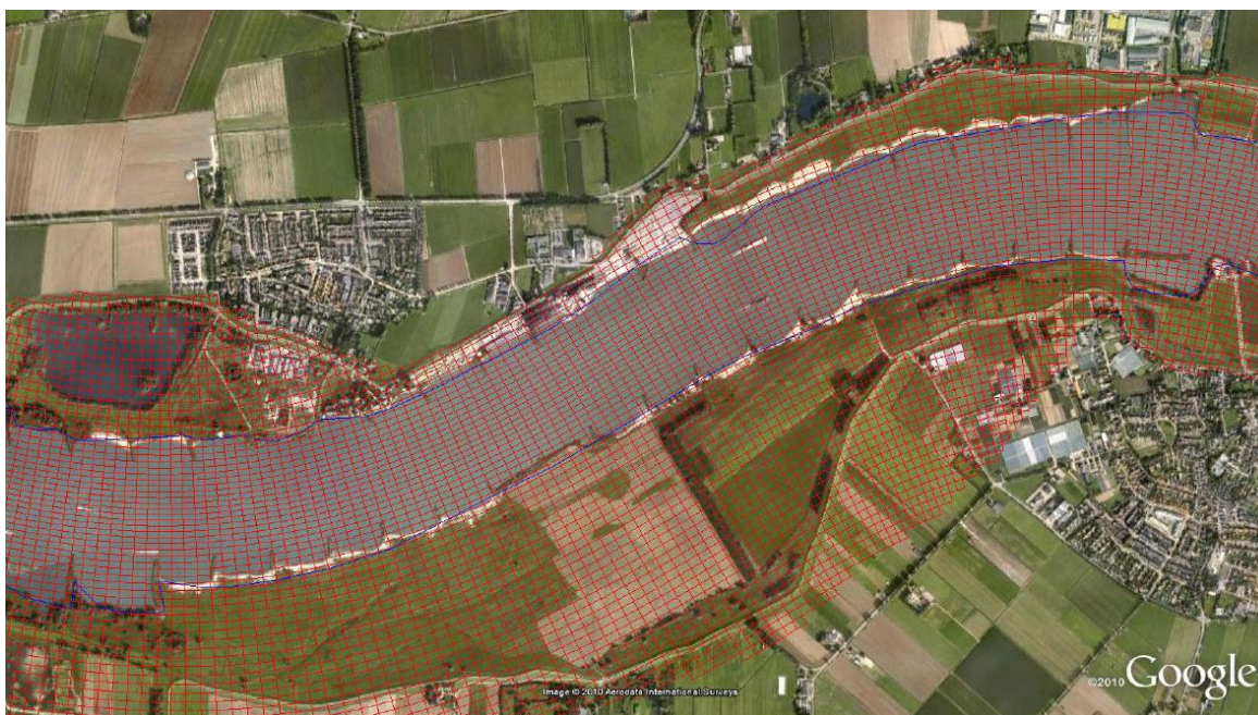
Figuur 3.6 Uitsnede van het rivierendomein van WAQUA-RMM waarin de roosterlijnen het zomerbed zoveel mogelijk volgen.
