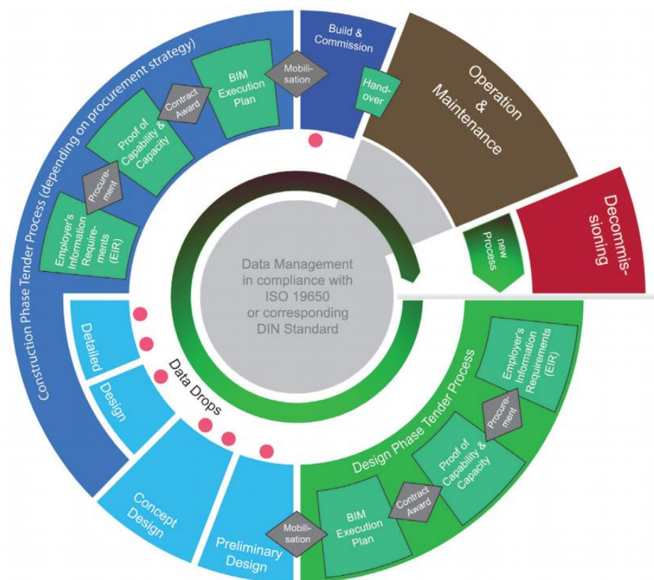
Figuur 5 Illustratie van het BIM-proces in Duitsland volgens de visie van BMVI (bron: BMVI, 2015 ).
