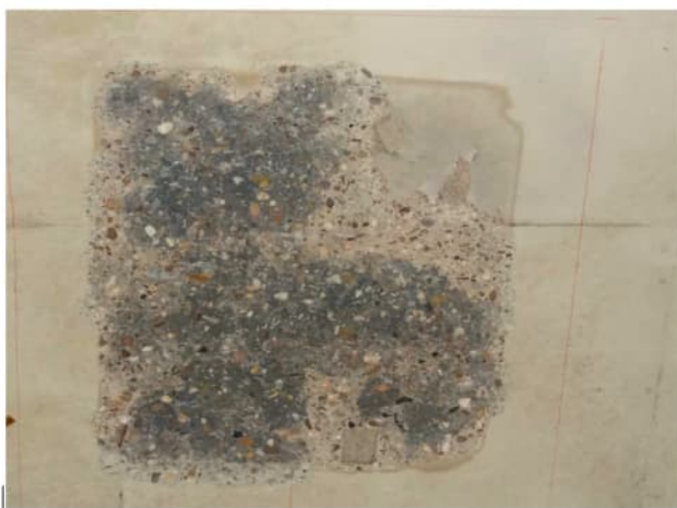
figuur 43 Foto's van gespat oppervlak na hitteproef op kaal beton in Salland-Twentetunnel [108].
