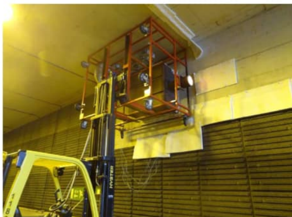
figuur 41 Hitteproef op de wand met de MobiFire®-RWS mobiele oven.
