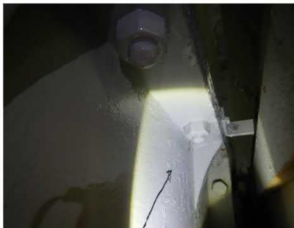
Figuur 4.1: Gespleten moer V-202109-880 (Niveau 1, Ring 3, paneel G)
