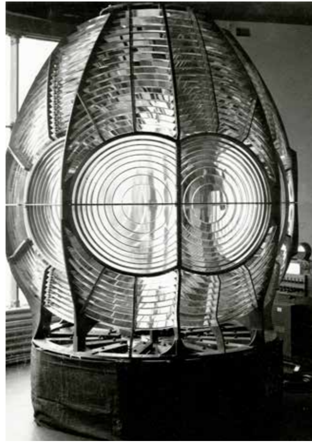
De nieuwe optiek voor de Lange Jaap in het proefstation in 1949.
