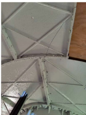
Foto 3: Scheur uitgehaald vloerdeel
