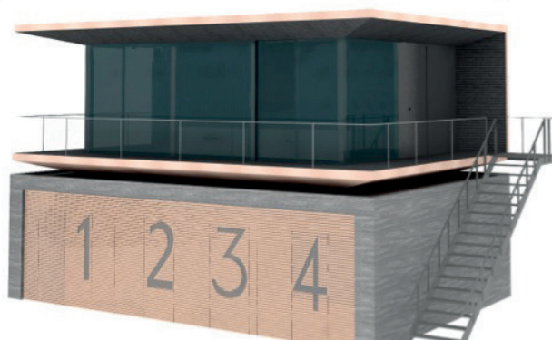
Figuur 7: Voor de Reevesluis bij Kampen is de verwachting dat een bediengebouw nodig is voor 5-10 jaar, omdat daarna sluisen naar verwachting op afstand bedienbaar worden. Voor het bediengebouw is daarom voor een verplaatsbaar bediengebouw dat later als (recreatie)woning gebruikt kan worden, de langdurig benodigde vaste installaties bevinden zich in een niet verplaatsbare begane grond. Dit is het resultaat van een intensief duurzaamheids traject tussen opdrachtnemer Isala Delta en Rijkswaterstaat. Beelden: NEXT architects
