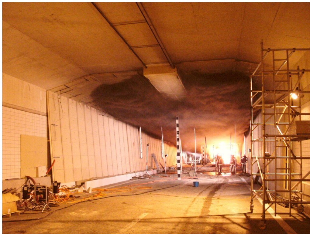
Figuur 3-5: Backlayering tijdens een full-scale testbrand in een verkeerstunnel (brandvermogen 20MW, ventilatiesnelheid 1,5-1,7 m/sec)
