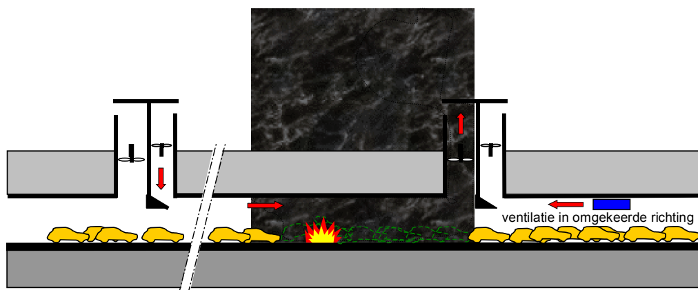
Figuur 2-23: Toe- en afvoer op regelmatige afstanden
