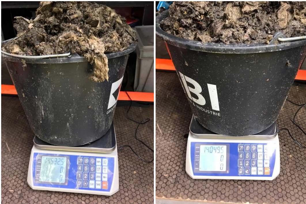
Figuur 4-5 Gewicht afgevangen sanitaire doekjes met de vuilfuik®, overstortput Steenwijk
