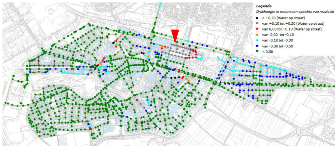
Figuur 2-1 Schematische weergave hydraulisch functioneren rioolstelsel Steenwijk bij bui 08 in toekomstige situatie 2025, de ligging van de vuilfuik® is weergegeven met een rood icoon (Rioolplan Steenwijk)
