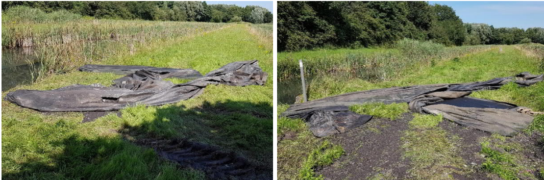
Figuur 4-7 Vuilfuiken® lichting overstortput Soest Biezenveld (het afval is verspreid over de gehele fuik, maar het meeste afval verzamelt zich in de teen van de fuik)
